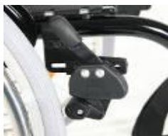
XES060002 Dźwignia blokady hamulca na wysokości kolan
